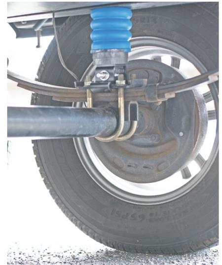
**EXAMPLE OF TRAILER SUMOSPRINGS INSTALLED VS FACTORY GAP**
