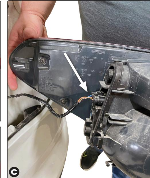
3. Débrancher le faisceau de fils du véhicule des douilles de feux arrière. Débrancher ce connecteur, en veillant à ne pas briser les pattes de verrouillage. Toutes les surfaces de contact des connecteurs doivent être propres et dépourvues de saleté.
