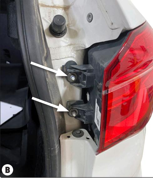
2. Retirez les feux arrière du côté conducteur et passager du véhicule. Après avoir enlevé les écrous, retirez soigneusement le feu arrière du véhicule en prenant soin de ne pas endommager les broches d'alignement.
