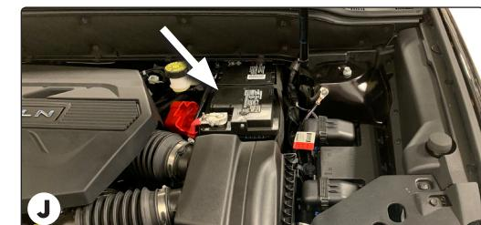
5. Localice un punto adecuado de conexión a tierra cerca del conector. (No perforo en el piso o base del vehículo). Limpie la suciedad y el anticorrosivo del área. Perfore un orificio de 3/32" y asegúrelo con un cable blanco usando el ojete y tornillo que se incluyen.
